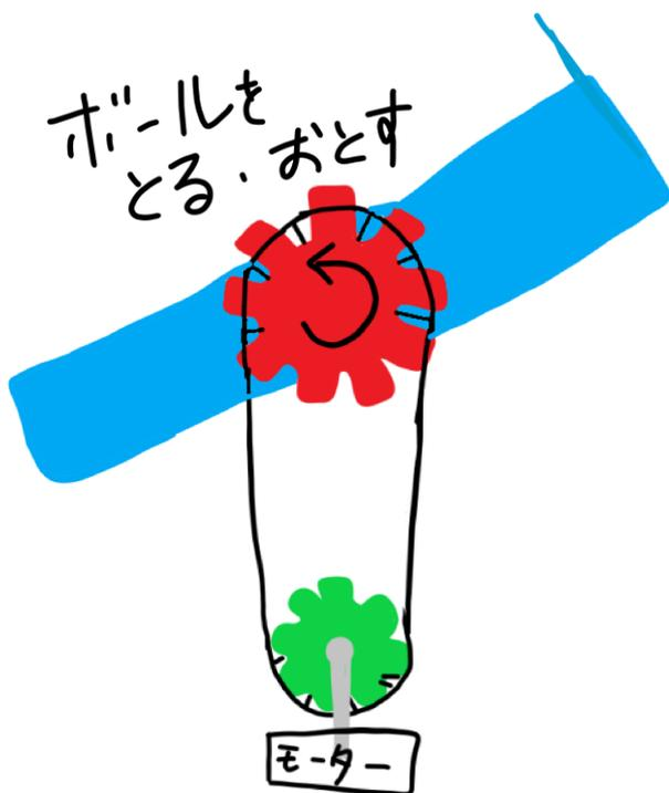
これらの図のようにモーターにギヤを付け、プラスチック段ボール（以下プラダン）部分（青色の部分。ボールをとったり所持したり落としたりする部分。）とつながるギヤとチェーンでつなげることでモーターの回転に合わせてボールをとったり落としたりできるようにしました。これらの図でいうとモーターを左に回転させたときにはボール落とせるような傾き、右に回転させたときはボールを所持できる傾きになるようになっています。
