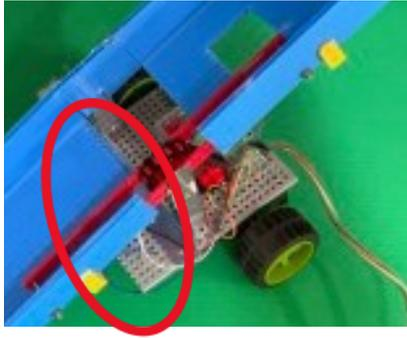
下の板の部分を短くすることで、上の部分のプラスチックを傾けると自動的に車体全体が傾き倒れるようにしました。そのほうが上のプラスチックが床にあたりやすくなり、ボールをとるのが簡単になりました。
