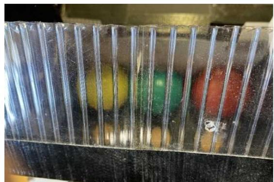
⑥ 透明なプラスチック段ボールを使うことで中にボールがいくつ入っているかが分かる。(余分にボールを取ることがなくなる)
