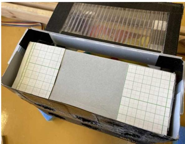
③ ボールをスポットへ乗せる時に、車体を傾ける必要があり、傾けた勢いでボールが落ちてしまうので、ボールが出ないようにした。
