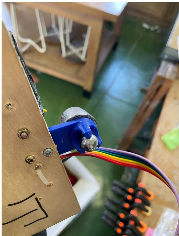
高速設定で動き回るロボットには、3Dプリンターで作ったキャスターが使われています。
