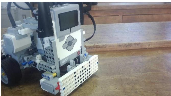
このようにすることで、壁に接触した際に、横長の板の働きにより、ロボットを自然と壁に対して垂直にすることができます。斜めに走ってきたロボットの角度をリセットできるため、異なる場所を走ることができ
