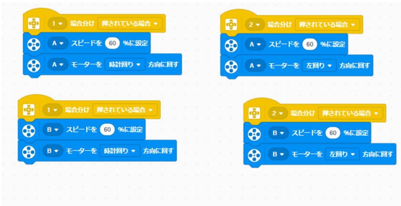
このようなプログラムを組んでいます。このプログラムは、まずセンサー2（後方のセンサー）が押されると前に進み、センサー1（前方のセンサー）が押されると後ろに進む、また何度も同じ位置を往復しないようにするため前に進むときだけスピードをそれぞれ左57%、右60%の速度とする、というプログラムで、コート左端に触れるまでずっと進み続けることができ、今回のルールにあるリトライが3回までというものに対して、1回のみリトライで動かせるようになりました。
