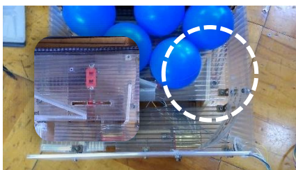
図 22 アイテムの詰まり
