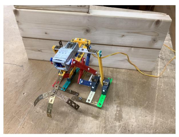
このロボットの主な特徴は前方に熊手のようなものがついていることです。そして重量は234gと少し低めでモーターが二個ついているロボットなどはもちろん、大抵のロボットより重量が軽いです。
