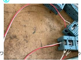
導線にY型圧着端子を取り付けます。
