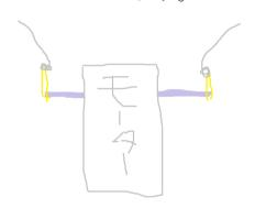
簡単に表すとモーターはこのなっています。このモーターが動くこと で黄色の部分が回り、線が鉄棒に巻き付けられるわけです。
