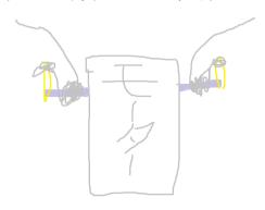
また、黄色の部品の線を巻き付けるところと鉄棒にはめるところを最大限離すことで、線をまくときに、黄色い部分が大きく回るため、少ない時間で線をたくさん巻き付けることが可能。
