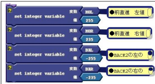
変数名の MO は前進回転の略。BA は後進回転の略です。L は左モータ、R は右モータです。前進の回転量は 1~255。後進は-1~-255段階になり、0 から離れるほど速く回転します。左図では MOL 変数に 255 を、MOR 変数にも 255 を代入しているのです、このままモータに出力すれば、全力で前進回転します。同じように、後進には BAL、BAR 変数を使います。しかし、モータにはバラツキがあり、同じ回転段階をモータに出力してもまっすぐ進みません。解決策としては、下
