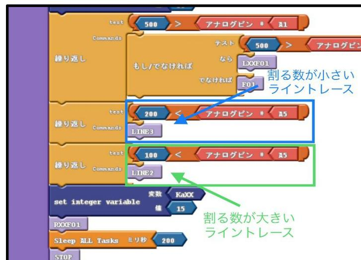
大きくずれた際の復帰が早くなりますが、線に沿う際にブレが大きくなり、直進性が低くなってしまいます。そこで、ラインレースの初めは割る数の小さいラインレース、途中から割る数を大きくしました。これにより、最初の位置の誤差が大きくても、ラインレース終了時の姿勢を安定させることができました。
