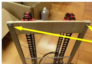
コの字型アングルに4mm厚の合板をはめこみ、その隙間にアクリル板をはさむと、なめらかに上下するプレートができます。
