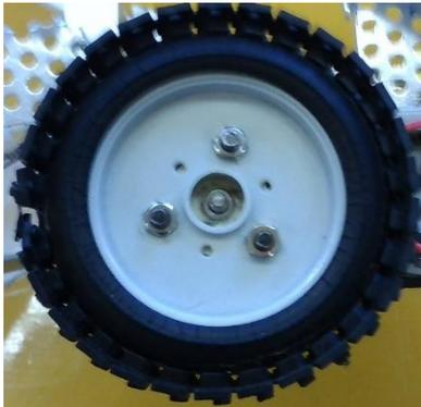
タイヤをスポーツタイヤのみのものにショート段差が乗り越えられないので写真2のように、ナロータイヤにキャタピラをつけることにより、タイヤが段差を乗り越えられるようにした。
