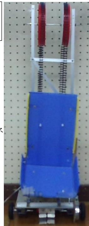
・ ロボコンのルールに30cmの高さ制限がありそれを突破するためにバネを使い写真1のように折りたたんで写真2のように立てるようにした。
