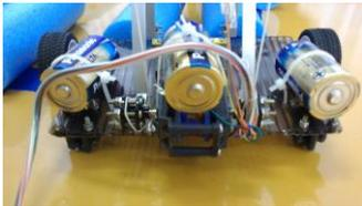
土台の後ろにギアボックスがついていて（ハイパワーギアボックス6速）その先に糸巻がついており、それでいとをまいてアームを上げています。下げるときは糸を緩めてアームの先のギアボックスの重さで下に下がるという仕組みになっています。しかし、ちょっとした欠点があります。
