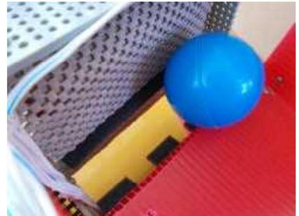
ボールは、前の滑り止めで作ったローラーですくい上げる。ラダーチェーンでつなげた下のローラーを動かすだけで上まであげることができる。隙間テープではじくことでボールを台に乗せやすくした。
