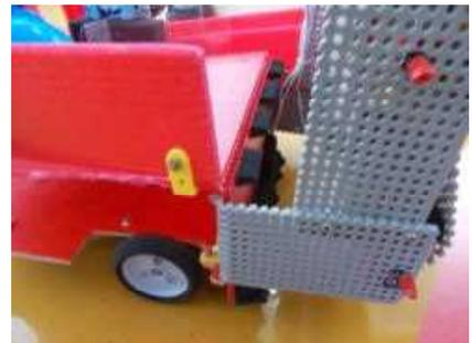
ローラーは、サランラップの芯に丸くカットした12mm厚の板材を入れ、ギアボックスと接続した。ボールが入りやすいように、サランラップの芯に隙間テープを貼りクッションにした。受ける台にも隙間テープを貼ることでボールが上がりやすくなる。ナットレスプレートを使用するのは、入りやすい高さや幅を調整するのに適しているからである。
