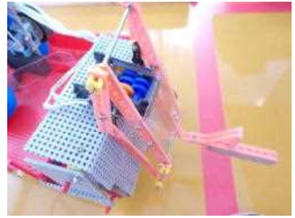
平行クランクを使用したフロントのアームは、プラスチックのフレームで製作した。炎ブロックをよけたり、制御ロボットが不調の時でもご当地キャラを救出することができる。
