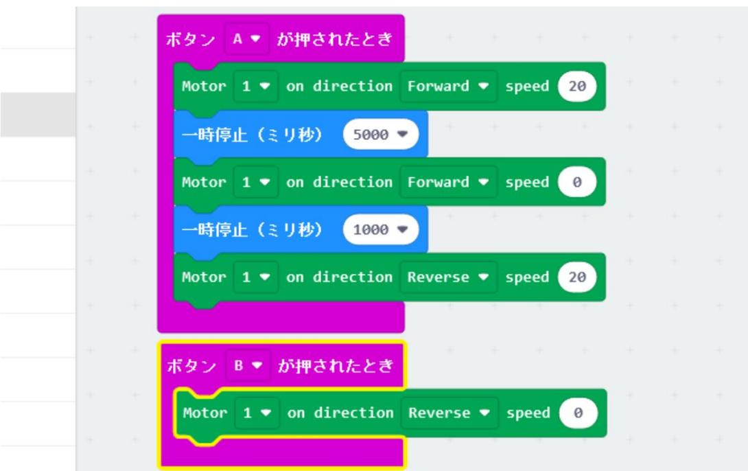
最後にプログラミングの説明です。今回はプログラミングを3回変更しました。最初は、超音波センサー使用のプログラミングでした。図5が最初のプログラミングです。これは、超音波センサーが1m以内に壁を感知したら、5秒止まるプログラミングで、そのあと、戻るプログラミングです。しかし、これはアームをでかくしたり、スピードが速すぎてぶつかったりしたので変更しました。
