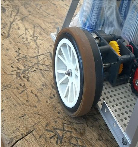
タイヤには太い輪ゴムをつけている。もちろん滑り止めとしての意味もあるが、左右で若干高さが違い、またタイヤの補助でつけているボールキャスターもタイヤよりも若干高いため、その微差を輪ゴムで調整しタイヤが空回りするのを防いでいる。また、これは尊敬している先輩方の知恵で、輪ゴムにゴミが付き滑り止めの効果がなくなってきたときは右のラバークリーナーフォームを使って輪ゴムの掃除をするとゴミがきれいに取れて滑りにくくなる。
