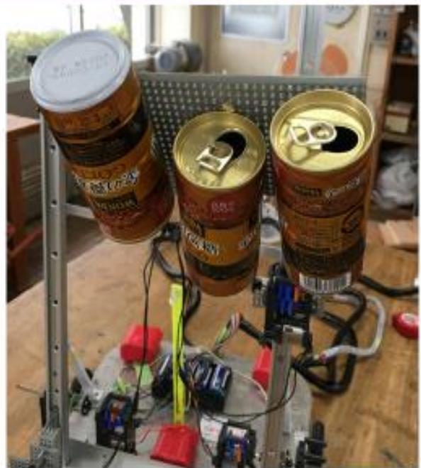
アームはギヤボックスに直付けしてあり、底面には、ネオジム磁石を取り付けている。その磁力で一度に3つまでスチール缶を保持することができる。
