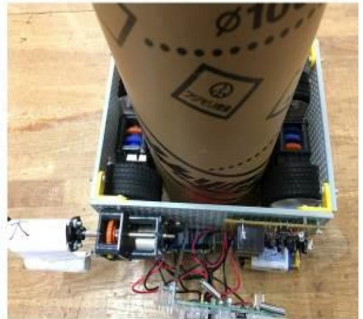
4本のタイヤの摩擦で落下することはない。プログラムが動作すると、それぞれのギヤボックスが逆回転し、ポイド管を登っていく仕組みである。
