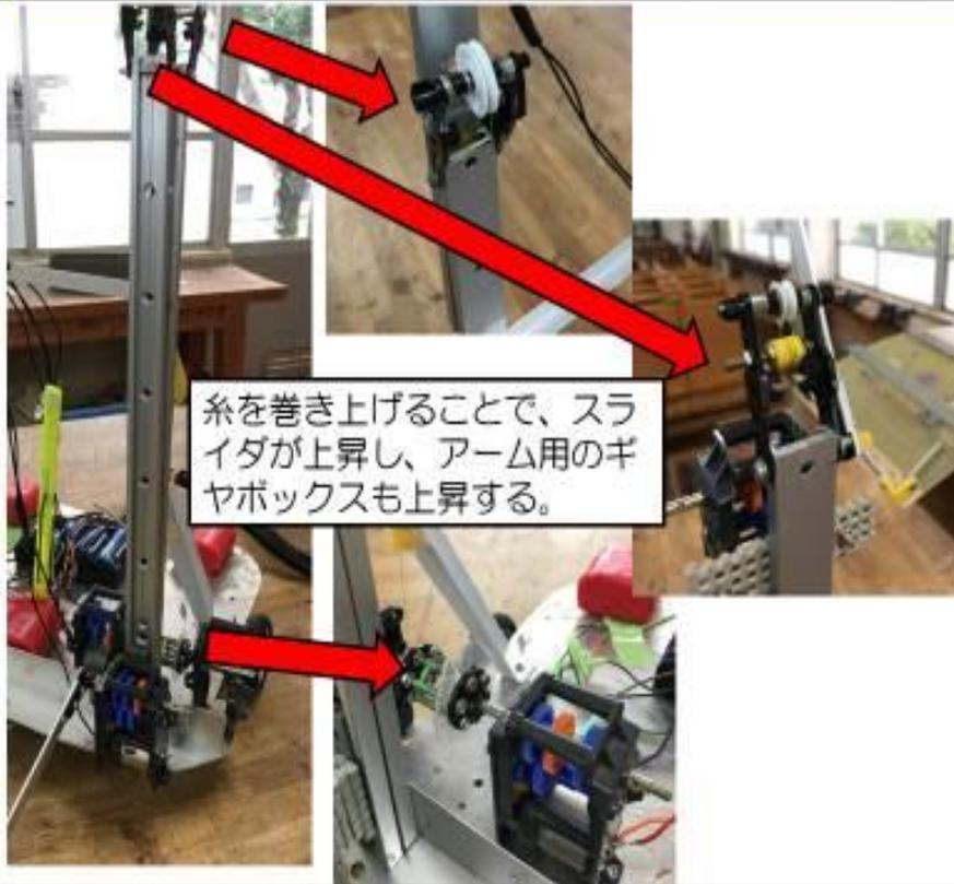
糸を巻き上げることで、スライダが上昇し、アーム用のギヤボックスも上昇する。
