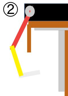
・上下させる機構は、6速ギアに②の写真のようにタコ糸をタイヤのゴムをはずしたもの（プーリー）で巻いて、③の写真を通し牛乳パックの後ろにつけたステンレス万能金具に結び持ち上げる機構になっています。
