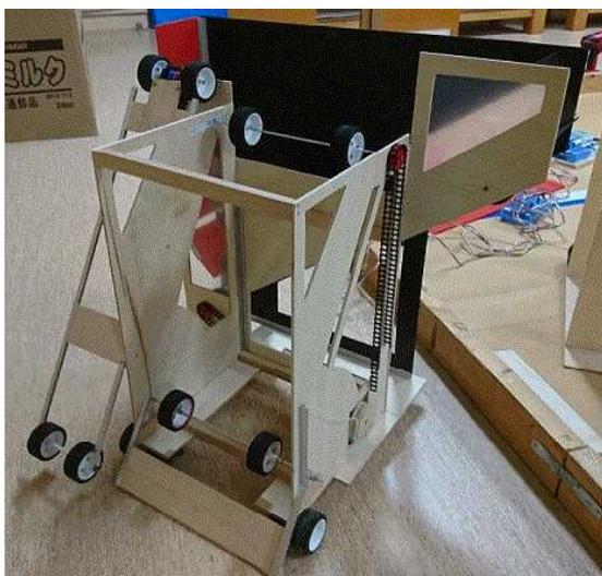
強度的にも強さを確保しながらなるべく軽量化も図りたかったため、糸のこ盤で各部分を切り抜きました。
